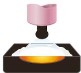
Более широкая зона очистки, меньшее проплавление
